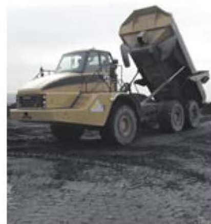
Einer der neuen Cat-Dumper 735 beim Abladen von kontaminierten Material im Einsatz für die Wismut.
